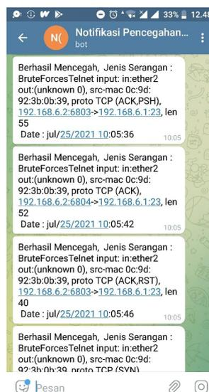
Gambar 3.6 Notifikasi Serangan *Brute Force* Telnet pada *Telegram*
