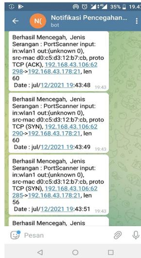
Gambar 3.8 Notifikasi Serangan *Port Scanner* Telnet pada *Telegram*
