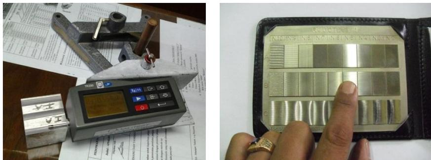
Gambar 8 : Pengujian Kekasaran Permukaan Dengan Alat Qualitest TR 200 dan Rugo Test
