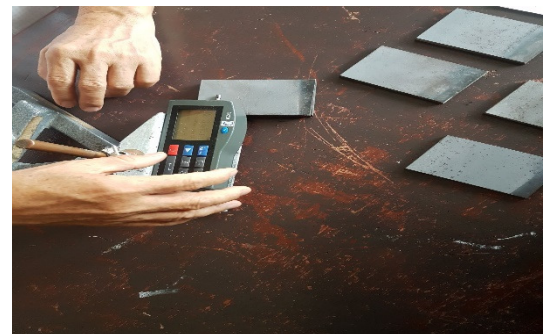
Gambar 3. Proses Pengujian Kekasaran Permukaan
